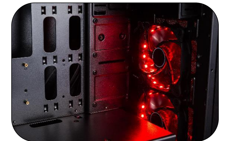
Wbudowane od frontu dwa podświetlane wentylatory 120 mm
