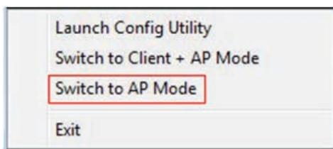
Można zmienić SSID w oknie konfiguracji trybu AP oraz kontrolować liczbę podłączonych klientów, przez konfigurację Access Control List, która bazuje na adresach MAC.
