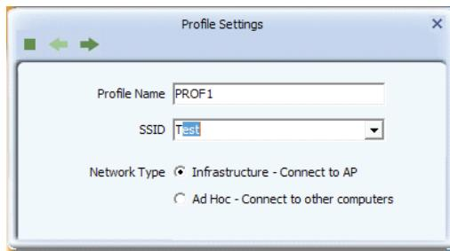
Kliknij przycisk "Następny" by przejść do konfiguracji uwierzytelnienia. Dobierz odpowiednie szyfrowanie zgodnie z wymaganiami sieci z którą karta ma się łączyć oraz podaj odpowiednie hasło.
