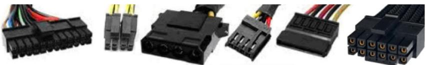
Le nombre et le type des connecteurs d'alimentation dépend du modèle du bloc d'alimentation. Lors de la sélection l'utilisateur doit prêter attention non seulement à la puissance d'un bloc d'alimentation, mais aussi à la quantité requise des connecteurs, la taille du bloc d'alimentation et le mode de sa mise en place dans le boîtier. Certains modèles d'alimentations MODECOM ont un câblage modulaire permettant la sélection de la bonne quantité de câblage nécessaire.
