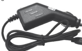
[Uwaga] Aby uniknąć uszkodzeń powodowanych przez udar prądowy, podłączyć ładowarkę samochodową dopiero po uruchomieniu pojazdu.
