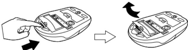
2. Włóż dołączone akumulatorki. Upewnij się, że biegun dodatni (+) oraz ujemny (-) akumulatora pasuje do polaryzacji wewnętrz schowka na baterie.
