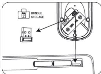
Le nano-récepteur doit être connecté à un port USB de l'ordinateur.
