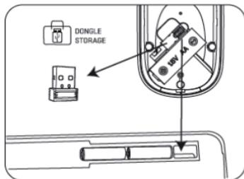
Receptorul nano trebuie să fie conectat la un port USB de pe computer.
