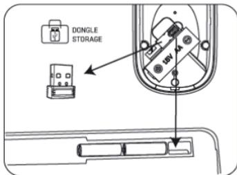
Der Nano-Empfänger muss an einen USB-Anschluss des Computers angeschlossen sein.
