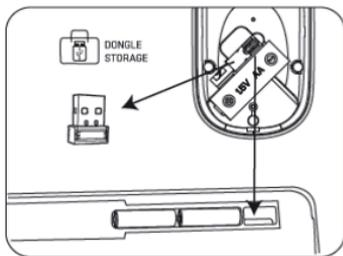
Наноприемник должен быть подключен к USB-порту компьютера.
